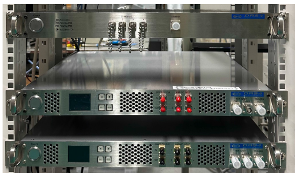
図1：20.48 GHzサンプリングの3ビットADCとFPGAモジュールから構成される10.24 GHz広帯域分光計の写真。分光計ユニット全体では 10.24 \times 8 = 81.92 GHzをカバーする。最上段は20.48 GHzのサンプリングクロックユニット。
